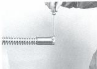
Afb. 53: Samendrukken van de dichtring voor de stuurbuis
