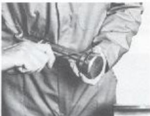
Afb. 33: Samendrukken van de beitedichtring met de slangklem
