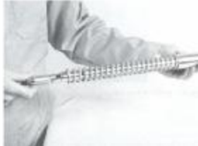
Afb. 63: Erop schuiven van de drukveer
