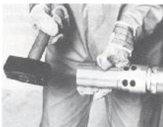
Afb. 41: Vastzetten van de trappenkop de beitel
