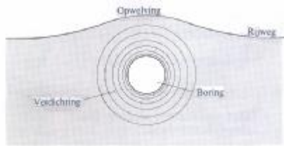
Afb. 6: Verdringing van de grond bij te geringe gronddekking
