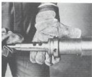
Afb. 29: Met de hand eruit draaien van het voorstuk van het huis
