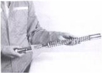
Afb. 60: Erf halen van het schakelblok
