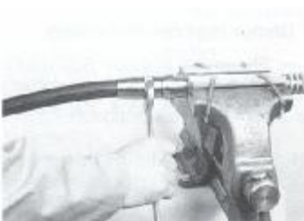
Afb. 58: Losdraaien van de slangmoer
