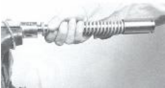
Afb. 68: Voorspannen van de drukveer
