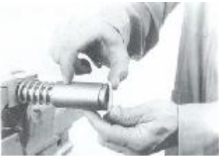
Afb. 52: Inzetten van de dichtring voor de stuurbuis
