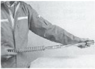
Afb. 61: Verwijderen van de drukveer
