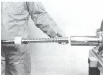
Afb. 54: Inbrengen van de sturing in het schroefstuk
