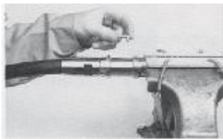
Afb. 57: Verwijderen van de verdraaiborg
