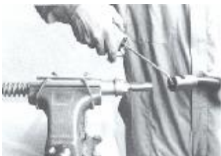
Afb. 66: Olie in het beginstuk van de aansluitslang laten lopen
