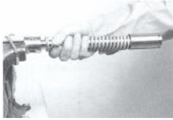
Afb. 59: Losdraaien van het schakelblok van de binnenbuis
