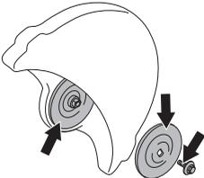
Verwenden Sie nur die von Husqvarna mitgelieferten Flanschscheiben, min. Durchmesser 105 mm.
