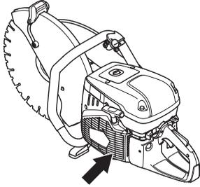
**ATTENTION !** Une prise d'air sale ou bouchée provoque la surchauffe de la machine, ce qui endommage le piston et le cylindre.
