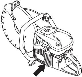
**HINWEIS!** Eine Verschmutzung oder Verstopfung des Luffeinlasses führt zur Überhitzung des Gerätes, die Schäden an Zylinder und Kolben zur Folge haben kann.
