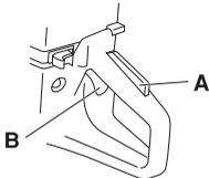
Die Sperre bleibt gedrückt, solange der Gashebel gedrückt ist. Wenn der Handgriff losgelassen wird, gehen sowohl Gashebel als auch Gashebelsperre in ihre jeweiligen Ausgangspositionen zurück. Dies geschieht durch zwei voneinander unabhängige Rückzugfedersysteme. Diese Stellung bedeutet, dass der Gashebel automatisch im Leerlauf gesperrt wird.
