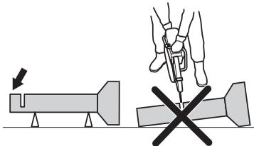
Wenn das Rohr durchhängt, so dass sich die Schnittstelle verengt, wird die Trennscheibe im Rückschlagbereich eingeklemmt und kann einen schweren Rückschlag hervorrufen. Wenn das Rohr ordnungsgemäß gestützt ist, fällt das Ende des Rohrs nach unten, die Schnittstelle wird verbreitert, und die Trennscheibe kann nicht eingeklemmt werden.
