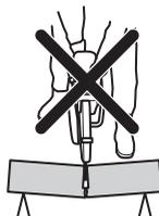
Si la lame se pince ou se coince dans la zone de rebond, la force de réaction va pousser la découpeuse vers le haut, puis la faire retomber en direction de l'utilisateur dans un mouvement de rotation qui peut causer des blessures sérieuses, voire mortelles. Faites attention aux éventuels mouvements de la pièce à travailler. Si la pièce à travailler n'est pas correctement soutenue et qu'elle se décale lors de la découpe, elle risque de pincer la lame et d'entraîner un rebond.
