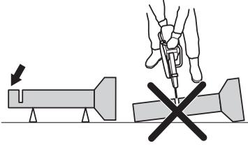
Als de buis kan doorbuigen en de snede kan sluiten, zal het blad worden vastgeklemd in de terugslagzone waardoor ernstige terugslag kan ontstaan. Als de buis voldoende wordt ondersteund, zal het uiteinde van de buis omlaag bewegen, waardoor de snede wordt geopend en het blad niet wordt vastgeklemd.
