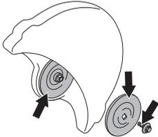
Gebruik alleen flensringen die worden geleverd door Husqvarna, min. diameter 105 mm/4,1".
