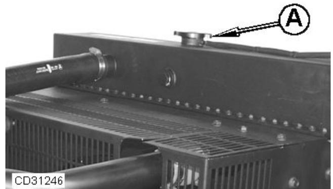
Retirez le bouchon du radiateur (A) et contrôlez le niveau de liquide de refroidissement qui doit se situer en bas de la goulotte de remplissage. Faites l'appoint de liquide de refroidissement dans le radiateur si le niveau est bas. Contrôlez l'absence de fuite dans l'ensemble du système de refroidissement.
